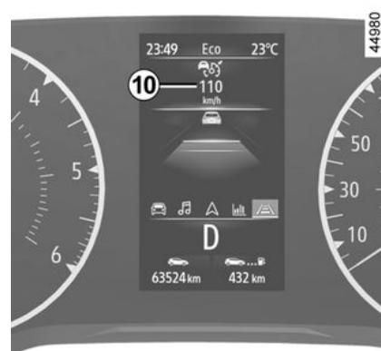
In qualsiasi momento è possibile superare la velocità di regolazione premendo il pedale dell'acceleratore.
