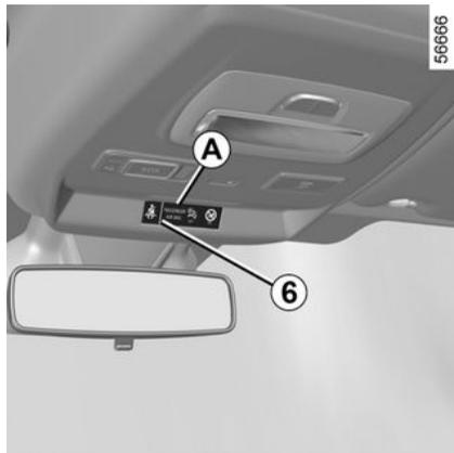
Questa spia viene visualizzata sul display centrale **A** all'inserimento dell'accensione del veicolo e se la cintura del conducente e/o del passeggero anteriore e/o posteriore (se il sedile del passeggero è occupato) non è allacciata.
