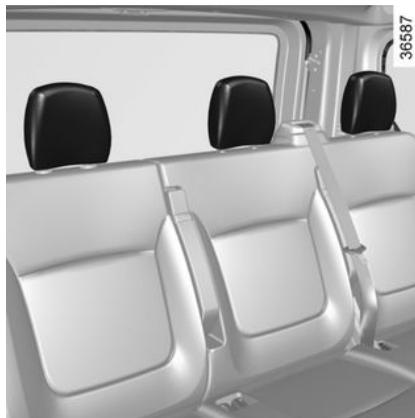
Introducete le aste dell'appoggiatesta nelle guide (se necessario, reclinare lo schienale). Abbassate l'appoggiatesta al massimo, quindi sollevatelo fino allo scatto. Verificare il corretto bloccaggio di ogni asta **2** sullo schienale del sedile.
