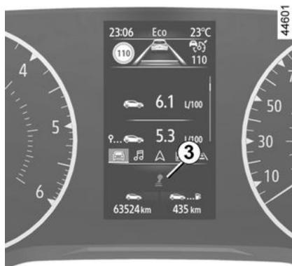
A seconda della versione del veicolo, per ottimizzare i consumi una spia sul quadro della strumentazione vi informa del momento più appropriato per inserire la marcia superiore o inferiore:
