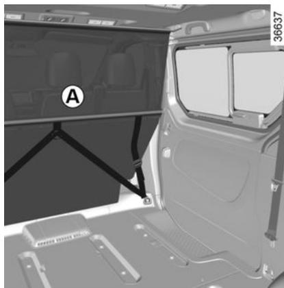
Per i veicoli che ne sono provvisti, la rete di separazione **A** è utile quando si trasportano animali o bagagli per isolarli della parte passeggeri.
