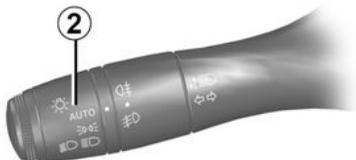
Le luci si spengono automaticamente dopo l'arresto del motore, all'apertura della porta del conducente o alla chiusura del veicolo. In questo caso, al successivo avviamento del motore, le luci si riaccenderanno secondo la posizione della ghiera 2.
