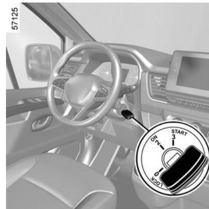
Ruotare la chiave di accensione nella posizione "ON" 2 e mantenerla in tale posizione finché la spia di preriscaldamento del motore non si spegne
