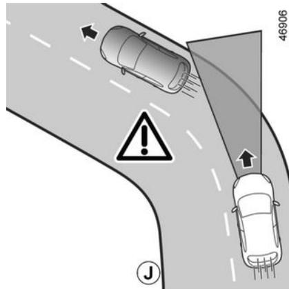
Quando ci si immette in un incrocio o in una curva, la telecamera potrebbe non essere temporaneamente in grado di rilevare il veicolo che precede (ad esempio **J**).
