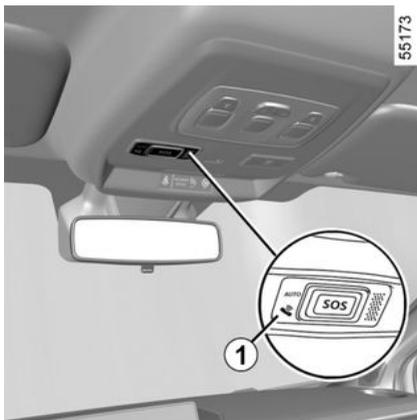
In alcuni casi, la chiamata di emergenza potrebbe non funzionare (ad esempio con la batteria scarica, ecc.).
