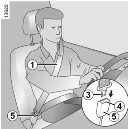
Svolgere la cintura **lentamente e senza strappi** e assicurarsi di bloccare la fibbia **3** nel modulo di bloccaggio **5**
