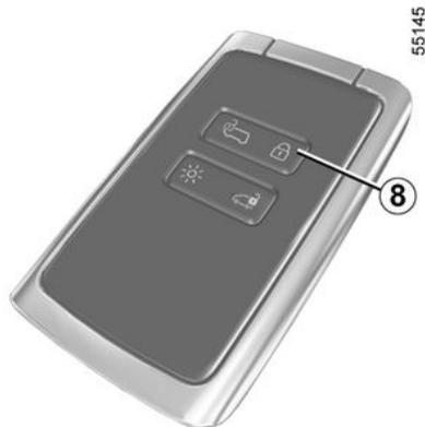
Se la carta è rimasta all'interno della zona di accesso **3** per più di 15 minuti, la funzione di bloccaggio quando ci si allontana dal veicolo viene disattivata. Per bloccare il veicolo, premere il pulsante **8** sulla carta.
