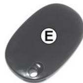
Permette di bloccare/sbloccare le porte del veicolo senza utilizzare il telecomando → **27**.
