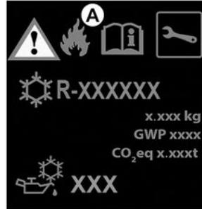
Il circuito del fluido refrigerante (di cui alcuni componenti sono ermeticamente chiusi) può contenere gas fluorurati a effetto serra.
