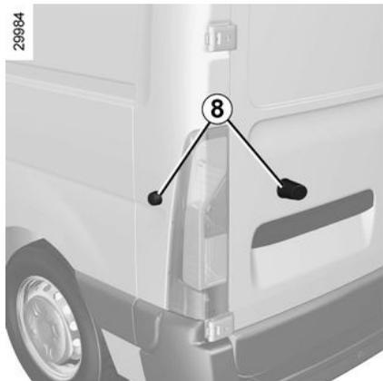
Rimuovete il tirante **7** dall'alloggiamento **5** per l'apertura a 180°. Aprire completamente la porta fino al contatto dei magneti **8**.
