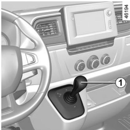
– Permette di inserire la prima marcia avanti, di selezionare la retromarcia e la posizione di folle e di cambiare la marcia manualmente.
