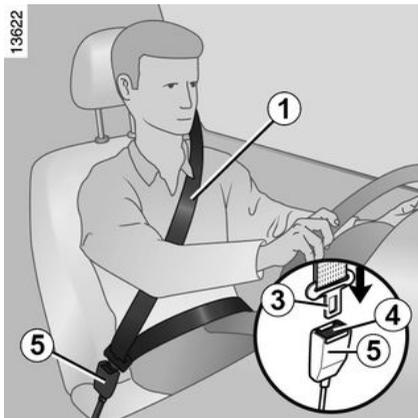
Svolgete la cintura **lentamente e senza strappi**, quindi assicuratevi di bloccare la fibbia **3** nel modulo di bloccaggio **5** (controllate che sia ben agganciata tirando la fibbia **3**).
