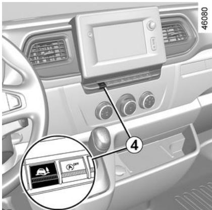
Premete il tasto **4**: sul quadro della strumentazione viene visualizzato il messaggio "Modalità terreno friabile".
