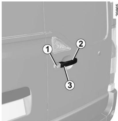
Sbloccate la serratura **1** utilizzando la chiave o, sui veicoli che ne sono equipaggiati, utilizzate il telecomando o il telecomando ad accesso vivavoce premendo il pulsante **3**. Sollevate la maniglia **2** verso di voi e aprite la porta.
