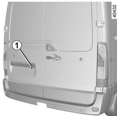
All'innesto della retromarcia, la telecamera **1** situata sul portellone o, a seconda del veicolo, sulla porta a battente posteriore trasmette una vista dello spazio dietro il veicolo sul retrovisore **2** o, a seconda del veicolo, sul display multimediale **3** accompagnato da una o due sagome **4** e **5** (mobile o fissa).
