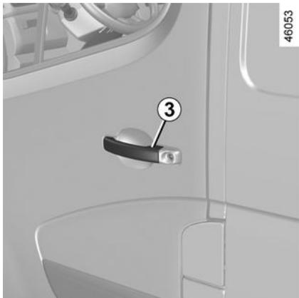
Con l'emettitore-ricevitore in una delle zone di accesso **2**, premete il pulsante **3** o **4**: tutte le portiere si bloccano.
