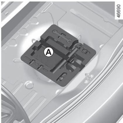
La dotazione degli attrezzi nella relativa cassetta varia a seconda del veicolo. La cassetta degli attrezzi **A** è disposta nel vano sotto il tappetino del bagagliaio.
