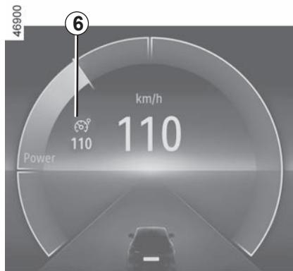
Per memorizzare la velocità corrente, premere il tasto **4** (RES/+) o il tasto **3** (SET/-): la velocità limitata sostituisce i trattini e, a seconda del veicolo, si accende la spia **6** bianca. La velocità minima registrata sarà di 30 km/h.
