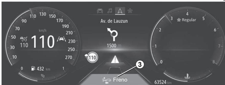
Se il veicolo è fermo a causa della frenata di emergenza attiva, il conducente deve tenere fermo il veicolo utilizzando il pedale del freno.
