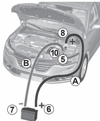
Fixez le câble positif **A** sur le **bornier 8 (+)**, puis sur la **borne 6 (+)** de la batterie fournissant le courant.
