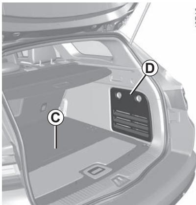
En cas de crevaison, utilisez le kit situé suivant véhicule sous le tapis de coffre **C** ou dans le rangement **D** à droite ➔ 3.56.
