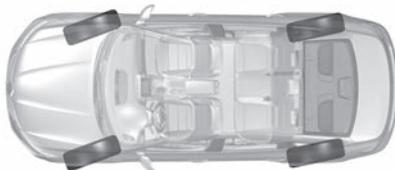
Lors de roulage à vitesse plus élevée, les roues arrière s'orientent dans le même sens que les roues avant (figure **B**) afin d'optimiser la stabilité du véhicule. Ceci est utile lors d'un changement de voie, lors de la prise de virage...
