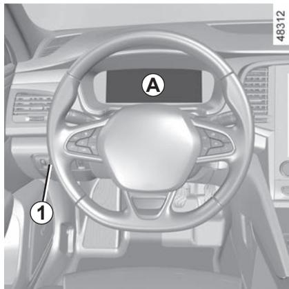
**Tableau de bord A** : il s'éclaire à la mise sous contact. Tournez la commande **1** vers le bas ou vers le haut pour régler l'intensité.
