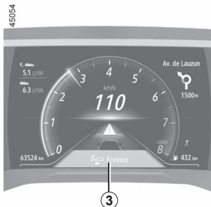
Si le freinage actif d'urgence a provoqué l'arrêt du véhicule, le maintien du véhicule à l'arrêt doit être réalisé par le conducteur en maintenant son pied sur la pédale de frein.
