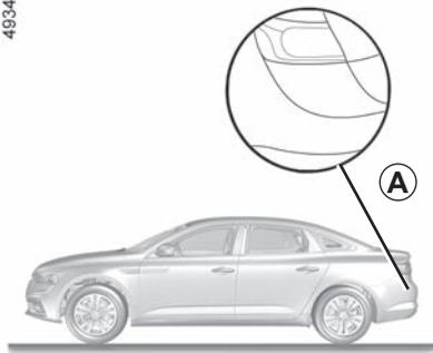
À partir des informations provenant des radars installés de chaque côté du pare-chocs arrière (zone **A**), la fonction avertit le conducteur lorsqu'un autre véhicule se trouve dans le périmètre de détection **B**.
