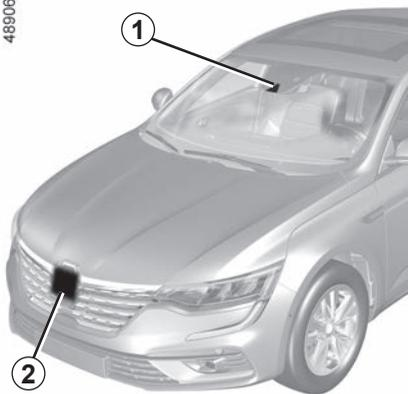
À partir des informations provenant du radar **2** et de la caméra **1**, cette fonction avertit le conducteur de l'intervalle de temps qui le sépare du véhicule qui le précède afin de respecter les distances de sécurité entre les deux véhicules.
