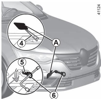
Utilisez exclusivement les points de remorquage avant 5 et arrière 7 (jamais les tubes de transmission ou toute autre partie du véhicule). Ces points de remorquage ne peuvent être utilisés qu'en traction. En aucun cas, ils ne doivent servir pour soulever directement ou indirectement le véhicule.
