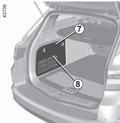
Suivant véhicule, pour les véhicules équipés d'un caisson de basse, ce dernier est situé derrière le portillon 8 du rangement 7.
