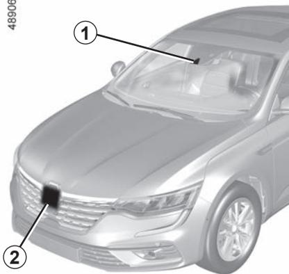
À partir des informations provenant du radar **2** et de la caméra **1**, le système détermine la distance qui le sépare du véhicule qui le précède et des piétons environnants.
