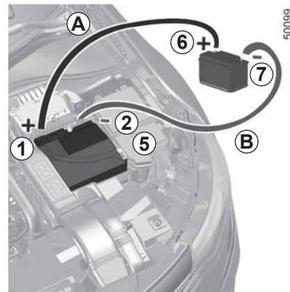
Fixez le câble positif **A** sur le **support 1 (+)** situé sous le cache du boîtier **3**, puis sur la **borne 6 (+)** de la batterie fournissant le courant.
