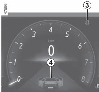
Lorsque le véhicule atteint 20 km/h environ, un témoin indique le ou les ouvrants (porte ou coffre) ouverts ou mal fermés, accompagné du message « coffre ouvert » ou « porte ouverte » et un signal sonore retentit pendant 40 secondes environ ou jusqu'à la fermeture du ou des ouvrants.
