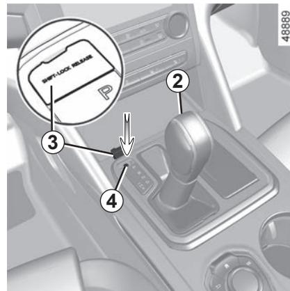
A la mise en route, dans le cas où le levier est bloqué sur **P** alors que vous appuyez sur la pédale de frein, il y a possibilité de libérer manuellement le levier. Pour cela, déclipsez la trappe **3**, puis passez un outil (tige rigide) dans le trou **4** et appuyez simultanément le bouton **2** afin de déverrouiller le levier.
