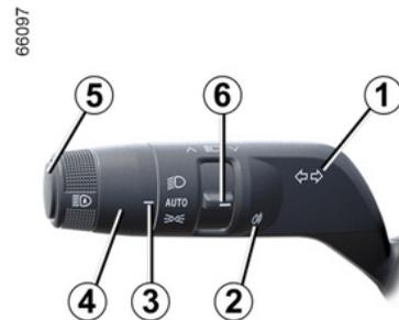
**D** Suivant véhicule, ce système allume et éteint les feux de route automatiquement.
