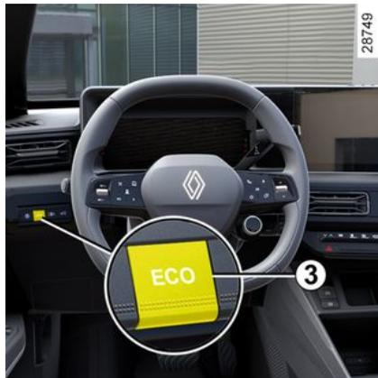
Pour les véhicules qui en sont équipés, appuyez sur le contacteur **3** pour activer le mode ECO.
