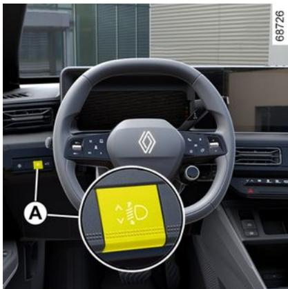
Suivant véhicule, le contacteur **A** permet de corriger la hauteur des faisceaux en fonction de la charge.
