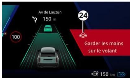
Lorsque la fonction « Centrage voie » ne détecte plus la présence de vos mains sur le volant, plusieurs niveaux d'alerte vont être effectués :
