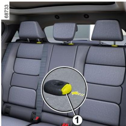
Basculez la banquette vers l'avant puis montez l'appui-tête au maximum puis appuyez sur le bouton 1 et sortez l'appui-tête.
