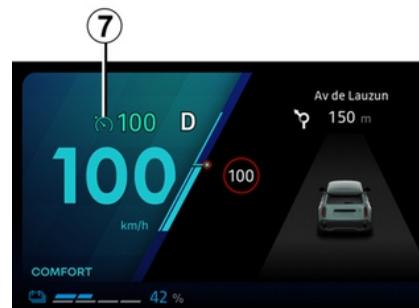
Appuyez autant de fois que nécessaire sur le contacteur 7 pour sélectionner le régulateur de vitesse.
