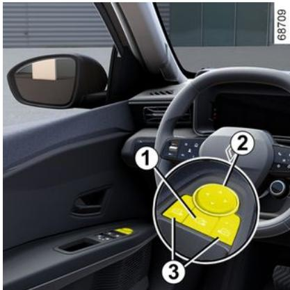
Sélectionnez le rétroviseur à l'aide d'un des contacteurs **3**, le témoin intégré au contacteur s'allume. Puis avec le bouton **2**, réglez-le jusqu'à la position souhaitée.
