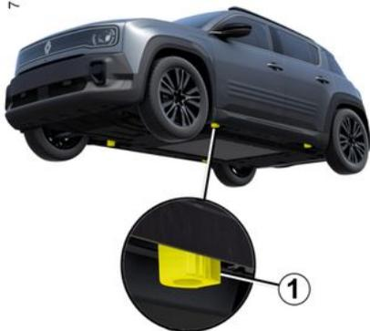
Votre véhicule dispose de quatre points de levage **1** dédiés situés sous le véhicule.
