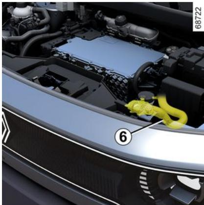
Le circuit électrique « haute tension » est reconnaissable aux câblages de couleur orange **6** et aux éléments repérés par le symbole
