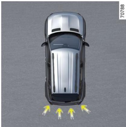
En complément de la fonction « Aides au parking » ➔ 285 et à partir des informations provenant des quatre capteurs centraux situés à l'arrière du véhicule, le système détecte les obstacles fixes se situant derrière votre véhicule. Si le risque de collision est important, le système freine automatiquement le véhicule.
