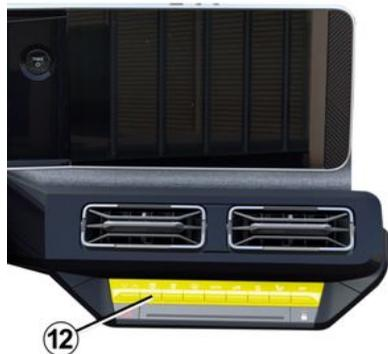
Pour contrôler le débit des aérateurs **1**, **4** et **6** appuyez ou levez la commande **12** en fonction de l'ouverture souhaitée.
