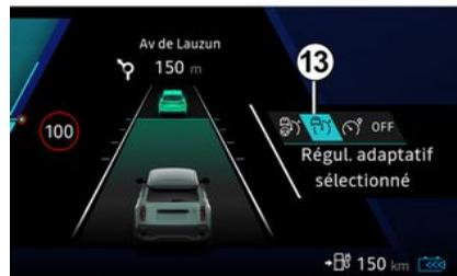
Appuyez autant de fois que nécessaire sur le contacteur **3** pour sélectionner en **13** le régulateur de vitesse adaptatif. Le témoin **9** s'allume en gris. Le message « Régulateur adaptatif prêt à repartir » apparaît au ta-
