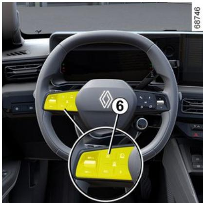
Pour adapter la consigne du limiteur de vitesse, du régulateur ou du régulateur de vitesse adaptatif aux limitations de vitesse détectées : faites un appui court sur le contacteur **6** pour adapter la vitesse du véhicule à la limitation indiquée sur le dernier panneau de signalisation détecté.
