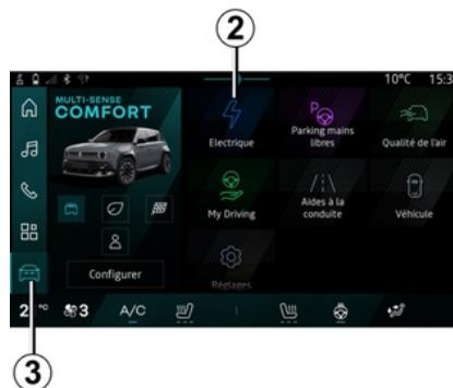
Véhicule à l'arrêt, moteur allumé, depuis le Monde « Véhicule » **3** de l'écran multimédia **1**, appuyez sur le menu « Electrique » **2** pour paramétrer la programmation de charge et/ou de confort de votre véhicule.
