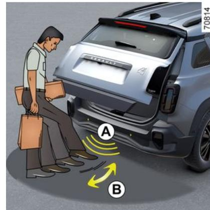
La fonction « mains libres » permet d'accéder au coffre les mains chargées. Assurez-vous que la carte se trouve dans la zone arrière du véhicule (zone **B**). Positionnez-vous à une distance de 45 centimètres environ du bouclier arrière du véhicule et effectuez un mouvement avant/arrière avec votre pied dans la zone **A**. Le capteur détecte l'approche puis, l'éloignement de votre pied et dé-
