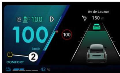
Ce système détecte une perte de pression dans un des pneumatiques en mesurant la vitesse des roues pendant la conduite.
