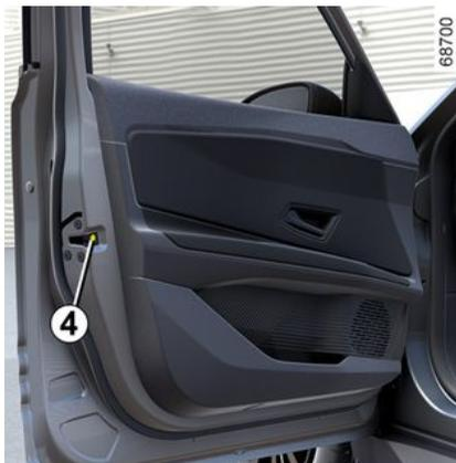
Porte ouverte, faites pivoter la vis **4** (à l'aide de l'embout de la clé) et fermez la porte.
