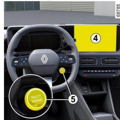
Suivant véhicule, appuyez autant de fois que nécessaire sur le contacteur **5** pour atteindre le mode ECO.
