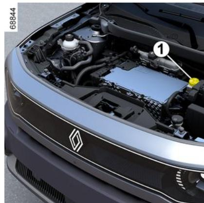
Le contrôle du niveau se fait moteur à l'arrêt et sur sol horizontal. Il est à contrôler souvent et, en tout cas, chaque fois que vous sentez une différence même légère de l'efficacité de freinage.
