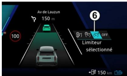
**i** Pour quitter les assistances de conduite, appuyez autant de fois que nécessaire sur le contacteur **7** jusqu'à OFF. Le message « Driving Assistance désactivé » s'affiche au tableau de bord. Dans ce cas, au prochain démarrage moteur la fonction « Limiteur de vitesse » sera en service et en attente de l'enregistrement d'une vitesse de limitation.
