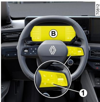
Suivant véhicule, naviguez à l'aide de la commande **1** pour sélectionner les différentes vues sur le tableau de bord **A** ou **B**.
