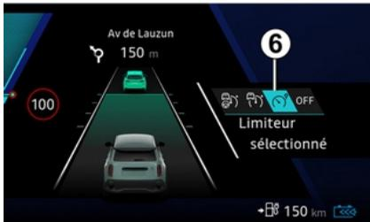
Appuyez autant de fois que nécessaire sur le contacteur 7 pour sélectionner le limiteur de vitesse.
