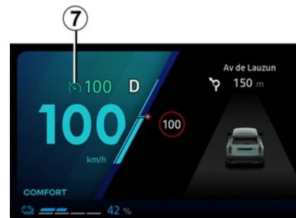
L'extinction du témoin 7 au tableau de bord confirme l'arrêt de la fonction.
