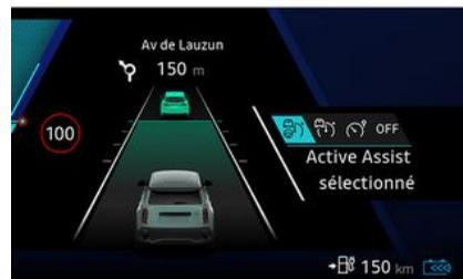
Pour activer la fonction, appuyer sur le contacteur **9** autant de fois que nécessaire pour la mettre en service.
