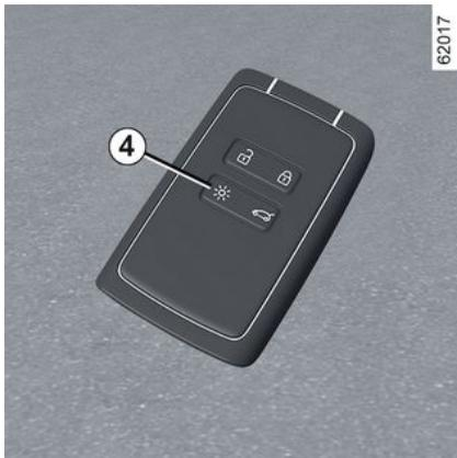
Un appui sur le bouton **4** allume les feux de croisement et l'éclairage extérieur pendant environ vingt secondes. Cela permet, par exemple, de repérer de loin le véhicule stationné dans un parking. Un appui long d'environ deux secondes sur le bouton **4** allume l'éclairage extérieur et émet un signal sonore.
