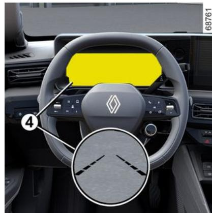
Fonction activée, le témoin
