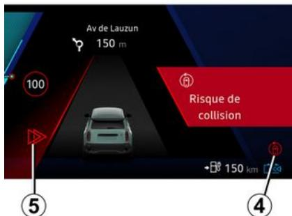
En roulage (vitesse comprise entre 65 km/h et 110 km/h environ), lorsqu'il y a un risque de collision avec un véhicule qui vient de la direction opposée sur une voie adjacente et se trouve dans le périmètre de détection **C**, sans avoir activé l'indicateur de direction, le système :
