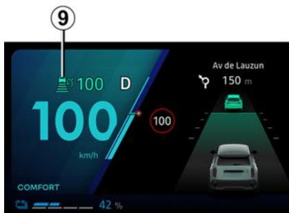
Le radar permet de détecter les véhicules qui vous précèdent. Le système ne peut pas fonctionner correctement si la zone du radar est occultée ou si son signal est perturbé.
