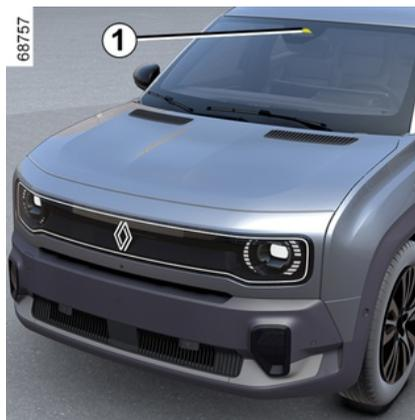
Le système affiche au tableau de bord les limitations de vitesse en fonction des panneaux de signalisation routière sur le bord de la route.
