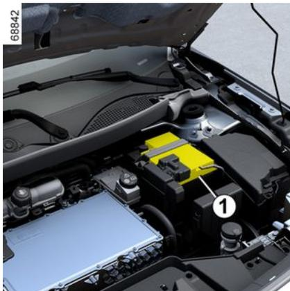
La batterie 12 volts fournit l'énergie nécessaire au fonctionnement des équipements du véhicule (feux, essuie-vitres, système audio...) et de certains systèmes de sécurité tels que l'assistance de freinage.
