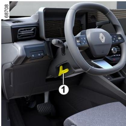
Abaissez le levier **1** et positionnez le volant dans la position désirée.
