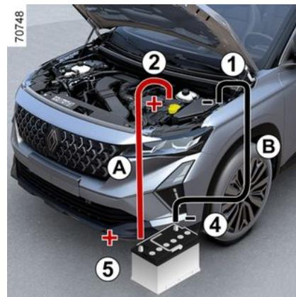
Fixez le câble positif **A** sur le **bornier 2 (+)**, puis sur la **borne 5 (+)** de la batterie fournissant le courant.
