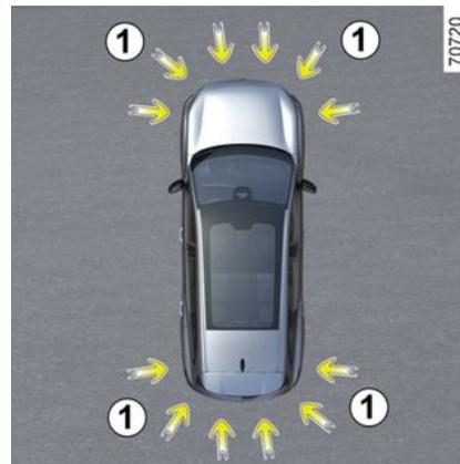
Des détecteurs à ultrasons indiqués par les flèches **1**, implantés dans les boucliers du véhicule, détectent les obstacles à proximité du véhicule.
