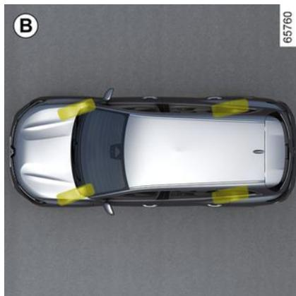
Lors de roulage à vitesse plus élevée, les roues arrière s'orientent dans le même sens que les roues avant (figure **B**) afin d'optimiser la stabilité du véhicule. Ceci est utile lors d'un changement de voie, lors de la prise de virage...
