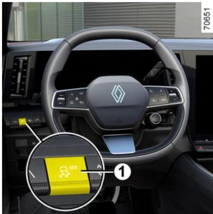
Dans certaines situations (conduite sur sol très mou : neige, boue... ou conduite avec des roues chainées), le système peut réduire la puissance moteur pour limiter le patinage. Activez la fonction par appui sur le contacteur **1**. Si cet effet n'est pas souhaité, il est possible de désactiver la fonction par appui long sur le contacteur **1**. Dans ce cas, le témoin
