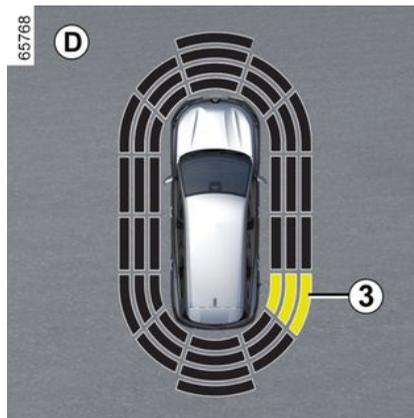
Suivant l'orientation des roues, le système détermine la trajectoire du véhicule et vous avertit du risque ou
