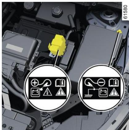
Utilisez le **bornier 1 (-)** et le **bornier 2 (+)** dans le compartiment moteur. Soulevez le cache **3** du **bornier 2 (+)**.
