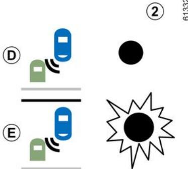
Premier avertissement : **indicateur de direction non activé**, l'indicateur **2** signale qu'un véhicule est détecté dans la zone d'angle mort et/ou qu'un véhicule s'approche rapidement par l'arrière sur une voie adjacente.
