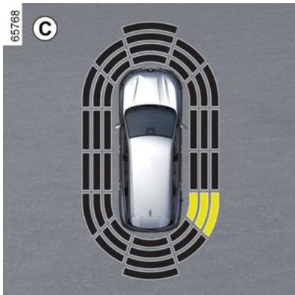
La plupart des obstacles se trouvant à proximité de l'arrière et suivant véhicule, de l'avant, et des côtés du véhicule sont détectés.
