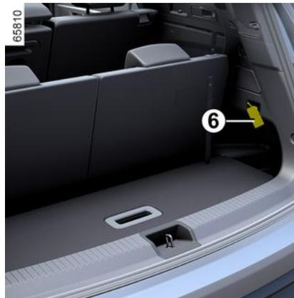
Déclippez (à l'aide d'un outil type tournevis plat) l'éclaireur de coffre 6 en pressant sur la languette côté gauche de l'éclaireur.
