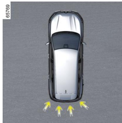
En complément de la fonction « Aide au parking » ➔ 284 et à partir des informations provenant des quatre capteurs centraux situés à l'arrière du véhicule, le système détecte les obstacles fixes se situant derrière votre véhicule. Si le risque de collision est important, le système freine automatiquement le véhicule.
