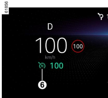
Le témoin **6** s'allume en gris. Le message « Régulateur prêt: SET pour activer » apparaît au tableau de bord accompagné de tirets pour indiquer que la fonction régulateur de vitesse est en service et en attente de l'enregistrement d'une vitesse de régulation.
