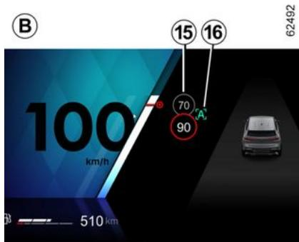
À l'aide de la caméra, de la fonction « Détection de panneaux de signalisation routière » → 225 et de la cartographie souscrite avec l'abonnement, le système anticipe l'adaptation automatique de la vitesse du véhicule jusqu'au franchissement d'un prochain panneau de limitation de vitesse identifié 15.
