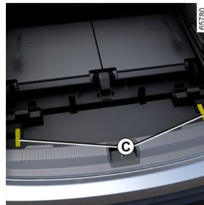
Suivant véhicule, tirez les sangles **C** pour faire basculer vers l'avant les sièges arrière de troisième rangée et ainsi accéder à la roue de secours.
