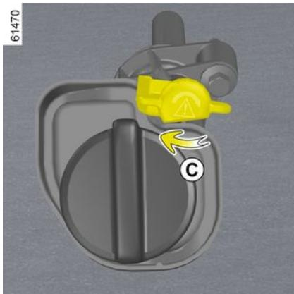
Suivant véhicule, il est nécessaire de verrouiller la jauge à huile : enfoncez la jauge jusqu'en butée, puis effectuez une rotation pour le verrouillage (mouvement **C**).
