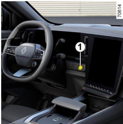
Appuyez sur le contacteur **1** sans appui sur les pédales pour la mise sous contact du véhicule. Appuyez sur la pédale de frein puis appuyez sur le contacteur **3** : le témoin **2** du
