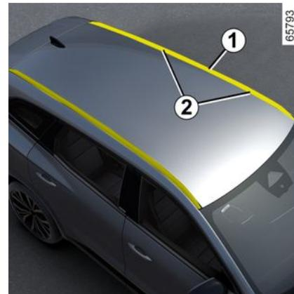
Les inserts de fixation **2** sont situés sur les barres de toit longitudinales **1**.
