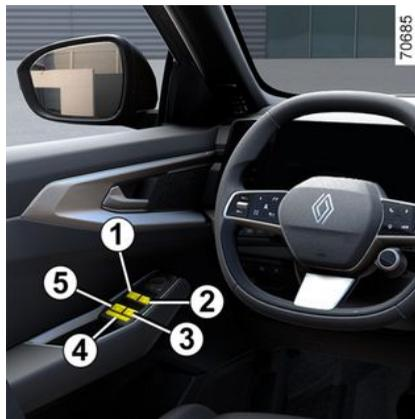
Appuyez ou tirez à fond et brièvement sur le contacteur d'une vitre : la vitre se relève ou s'abaisse complètement. Une action sur le contacteur arrête le fonctionnement de la vitre.
