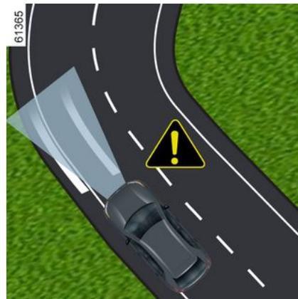
En cas de virage important et suivant la vitesse du véhicule, les capacités de maintien latéral de la fonction sont limitées et nécessitent l’intervention immédiate du conducteur sur le volant pour que le véhicule se maintienne dans la voie.
