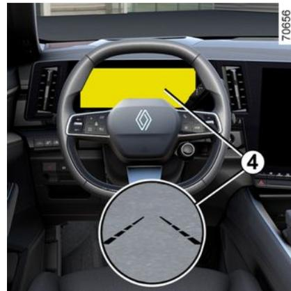
Fonction activée, le témoin
