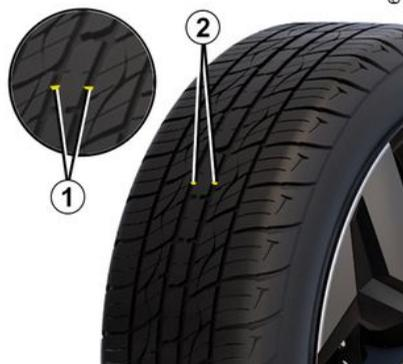
Lorsque le relief des sculptures a été érodé jusqu'au niveau des bossages-témoins, **ceux-ci deviennent visibles 2** : il est alors nécessaire de remplacer vos pneumatiques car la
