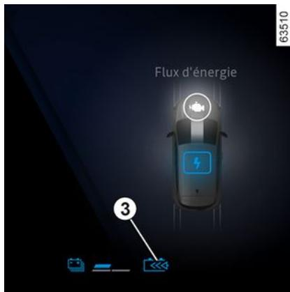
En relâchant la pédale d'accélérateur, le véhicule utilise le freinage régénératif pour ralentir le véhicule.
