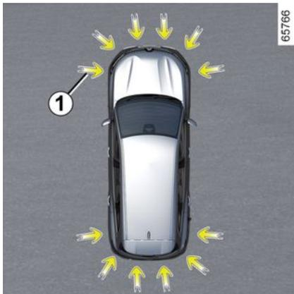
À l'aide de détecteurs à ultrasons indiqués par les flèches **1**, implantés dans les boucliers du véhicule, cette fonction vous assiste dans la recherche de places disponibles et accessibles, ainsi que dans la manœuvre de stationnement.
