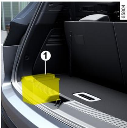
La batterie **1** se trouve dans le coffre du véhicule.
