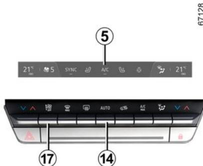
Le système agit sur la vitesse de ventilation, la répartition d'air, le recyclage d'air, la mise en route ou l'arrêt du conditionnement d'air et la température de l'air.
