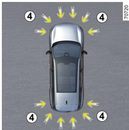
À partir des informations provenant des caméras **1**, **2**, et **3** implantées dans le bouclier avant, dans les rétroviseurs et sur le hayon, ainsi que des détecteurs à ultrasons **4** situés dans les boucliers du véhicule, la fonction vous aide dans les manœuvres difficiles (stationnement...) en affichant l'environnement du véhicule.
