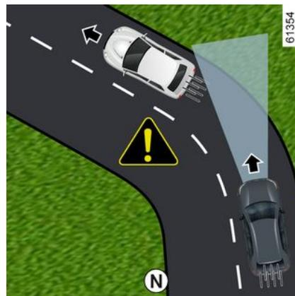
À l'entrée d'un virage et en courbe, le radar et/ou la caméra peuvent ne plus détecter temporairement le véhicule précédent (exemple **N**).
