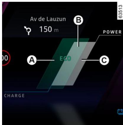
Le powermètre vous permet de connaître en temps réel l'énergie consommée ou récupérée lors du déplacement du véhicule.
