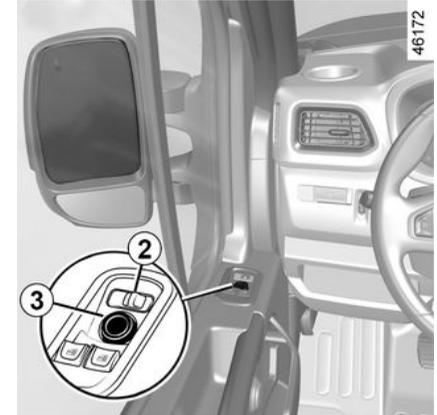
**Wählen Sie bei eingeschalteter Zündung** den Außenspiegel mit dem Schalter **2** aus und stellen Sie ihn dann mit der Taste **3** in die gewünschte Position.
