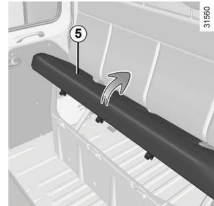
Die Sitzfläche **5** kann angehoben werden, um den Zugang zum Staufach unter der Sitzbank zu ermöglichen.
