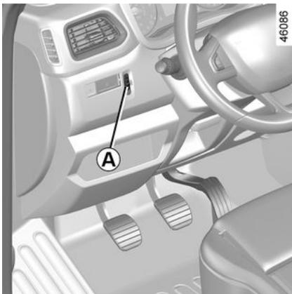
Bei Fahrzeugen, die mit dieser Funktion ausgestattet sind, können Sie mit dem Regler **A** die Strahlen je nach Beladung in der Höhe verstellen.
