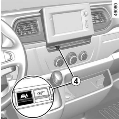
Drücken Sie den Schalter **4**: Auf der Instrumententafel wird die Meldung „Modus Weicher Boden aktiviert“ angezeigt.
