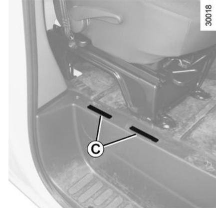
Abdeckung C mit einem flachen Schraubendreher oder ähnlichem Werkzeug lösen, um an die Fahrzeug-Ident-Nummer und Fahrgestell- oder Seriennummer zu gelangen.
