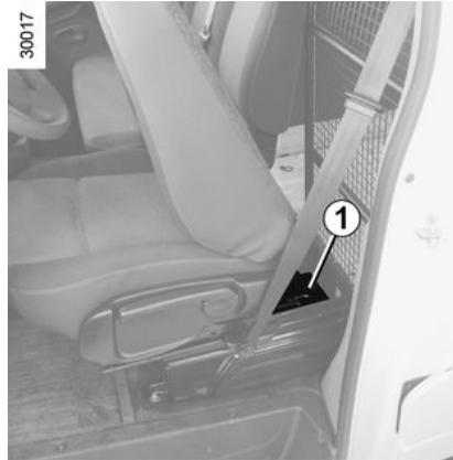
Je nach Fahrzeug ist im Falle einer Reifenpanne das unter dem Fahrersitz befindliche Set **1** zu verwenden.
