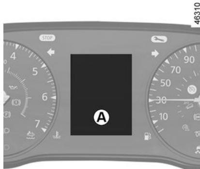
**Die Funktion wird aktiviert wenn** die Spur verlassen wird, ohne dass die Blinker eine Richtungsänderung anzeigen.
