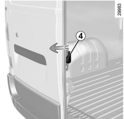
Ziehen Sie am Hebel **4**, um die Tür zu öffnen.
