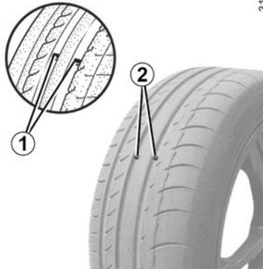
Die Reifen müssen in gutem Zustand sein und das Profil ausreichend Tiefe aufweisen; Reifen die die technische Abteilung genehmigt hat, verfügen über Warnstreifen **1** sie sind **an mehreren Stellen in die Lauffläche eingebaute Indikatoren**.
