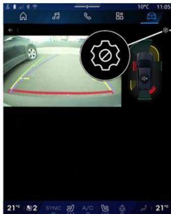
Beim Einlegen des Rückwärtsgangs wird die Rückfahrkamera am Heck des Fahrzeugs aktiviert, um das Bild der Situation hinter dem Fahrzeug auf das Multimedia-Display zu übertragen.
