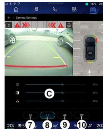
Drücken Sie im Menü „360°-Kamera“ das **2** Symbol für die Kameraeinstellungen. Verwenden Sie dieses Menü, um die Kamera zu konfigurieren:
