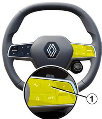
Sie können den Sprachbefehl für die Smartphone-Replikation ohne den Bildschirm verwenden, indem Sie die Taste **1** lange drücken. Eine Bestäti-
