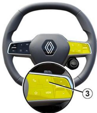
Halten Sie das Bedienelement **3** gedrückt, um die Spracherkennungsfunktion Ihres Smartphones zur Steuerung bestimmter Apps und Funktionen per Sprachbefehl zu aktivieren/deaktivieren.
