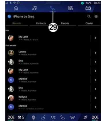
Die „Telefon“ Welt
