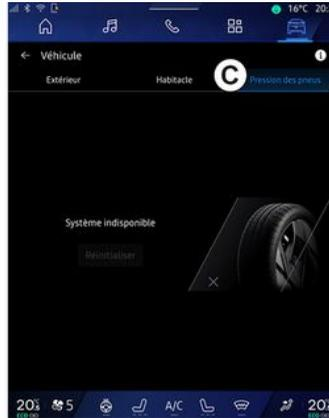
Verwenden Sie dieses Menü, um den Reifendruckstatus des Fahrzeugs zu prüfen und eine Rücksetzung durchzuführen.
