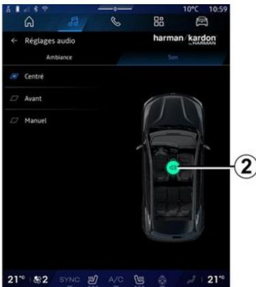
Diese Funktion ermöglicht das Einstellen der Klangverteilung. Drücken Sie auf „Zentriert“ oder auf „Vorne“, um die Klangverteilung für alle Insassen des Fahrzeugs oder für den Komfort der Fahrgäste im Fond zu optimieren (der Ton wird hinten ausgeschaltet und die Lautstärke vorn im Fahrzeug leiser gestellt).
