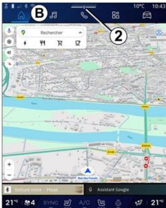
Kann mit der Schaltfläche **2** oder durch schnelles Wischen des Multimedia-Displays vom Bereich **B** zur Mitte des Bildschirms aufgerufen werden. Die Benachrichtigungszentrale ermöglicht den Zugriff auf den Benachrichtigungsverlauf, zum Beispiel:
