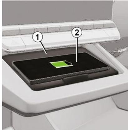
Verwenden Sie die Induktionsladezone **1**, um ein Telefon ohne Ladekabel aufzuladen.
