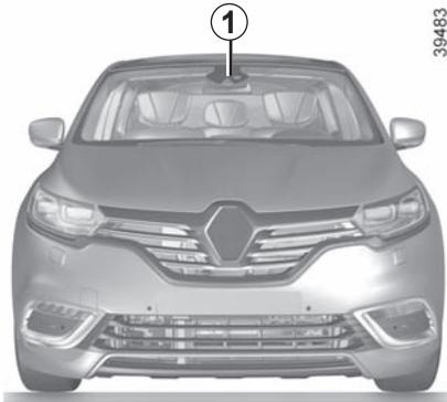
Die Warnmeldung bei Geschwindigkeitsüberschreitung mit Erkennung der Verkehrsschilder informiert den Fahrer beim Überschreiten der Geschwindigkeit auf dem Streckenabschnitt, auf dem sich das Fahrzeug befindet.
