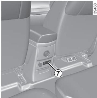
An den Steckdosen USB kann auch zugelassenes Zubehör aus dem Hersteller-Zubehörprogramm aufgeladen werden, dessen Leistung 12 Watt (Spannung 5 V) pro Steckdose nicht überschreitet.
