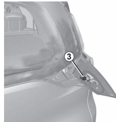
Ziehen Sie die Leuchteneinheit von außen heraus und lösen Sie den Lampenträger **3** um eine Vierteldrehung.
