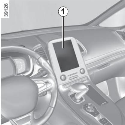
Diese im Multifunktions-Display **1** integrierte Funktion ermöglicht, je nach Ausstattung, die Aktivierung/Deaktivierung oder Einstellung bestimmter Fahrzeugfunktionen.
