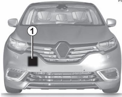
Mit Hilfe der Radarkamera **1** informiert diese Funktion den Fahrer über den Zeitintervall zwischen seinem und dem vorderen Fahrzeug, um die Sicherheitsabstände zwischen den zwei Fahrzeugen einzuhalten.
