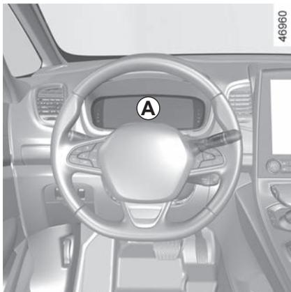
Die Instrumententafel **A** leuchtet auf, wenn die Zündung eingeschaltet wird.
