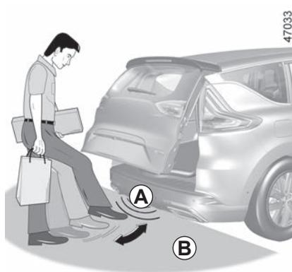
Der Sensor erkennt die Annäherung und Entfernung Ihres Fußes und löst das Öffnen oder Schließen der Heckklappe aus.
