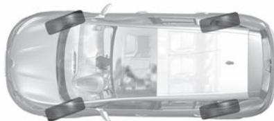
Bei einer höheren Geschwindigkeit bewegen sich die Hinterräder in die gleiche Richtung wie die Vorderräder (Abbildung **B**), um die Straßenlage des Fahrzeugs zu optimieren. Dies ist nützlich bei Spurwechseln, bei Kurvenfahrten ...
