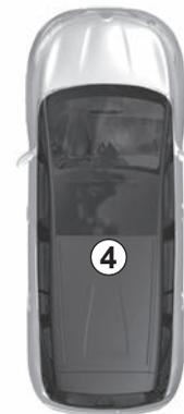
Wenn sich **bei laufendem Motor** nach dem Öffnen und Schließen einer Tür die Keycard nicht mehr im Bereich 4 befindet, erscheint die Meldung „Chipkarte nicht gefunden“, um Sie darauf hinzuweisen, dass sich die Keycard nicht mehr im Fahrzeug befindet. Dadurch kann zum Beispiel ein Wegfahren nach dem Absetzen eines Fahrgasts, welcher die Karte bei sich trägt, verhindert werden.
