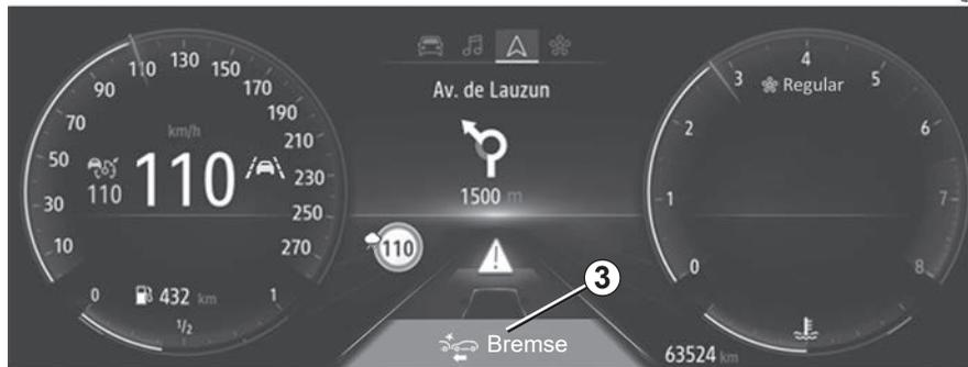
Wenn das Fahrzeug aufgrund einer aktiven Notbremsung zum Stillstand gekommen ist, muss der Fahrer das Fahrzeug durch Betätigen des Bremspedals halten.
