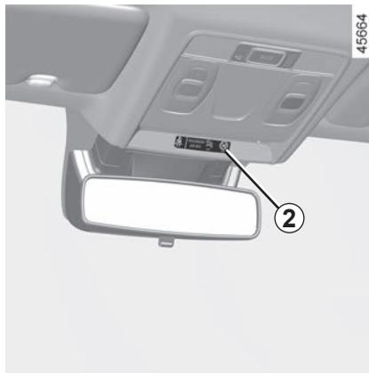
**Erneutes Aktivieren des airbags: Bei stehendem Fahrzeug und ausgeschalteter Zündung** die Verriegelung drücken und in die Stellung **1 ON** drehen.
