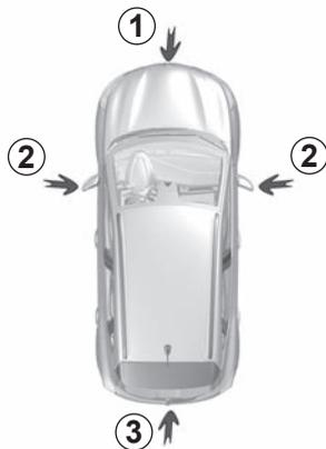
Unter Verwendung der Informationen der Kameras **1**, **2** und **3**, die sich im vorderen Stoßfänger, in den Türspiegeln und auf der Heckklappe befinden, sowie von den Ultraschallsensoren **4** an den Stoßfängern, hilft die Funktion bei schwierigen Manövern (z. B. Einparken) durch Darstellung der Fahrzeugumgebung.
