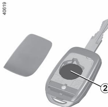
**Hinweis:** Den Elektronik-Stromkreis im Plipdeckel beim Batteriewechsel nach Möglichkeit nicht berühren.
