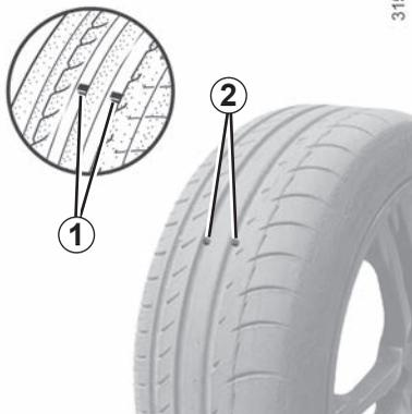
Wenn das Profil bis zur Höhe der Noppen abgefahren ist, **werden diese sichtbar**. **Die Reifen müssen 2** jetzt ausgetauscht werden, da die Profiltiefe nur noch **1,6 mm beträgt und somit die einwandfreie Bodenhaftung auf nassen Straßen nicht mehr gewährleistet ist**.
