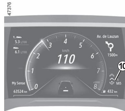
**Hinweis:** Je nach Fahrzeug kann in den Automatikmodus zurückgekehrt werden, indem die rechte Schaltwippe gedrückt und gehalten oder der Impulshebel **1** eine oder zwei Kerben nach hinten bewegt wird.
