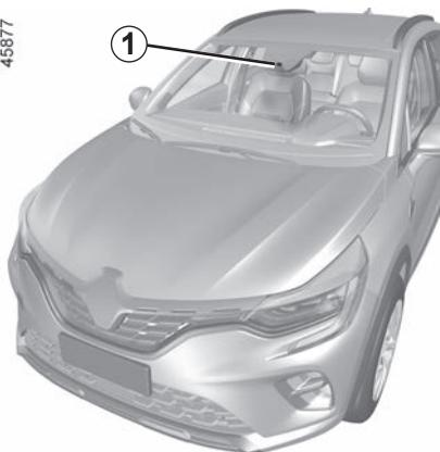
Anhand der Informationen der Kamera 1 warnt die Funktion den Fahrer beim Überfahren einer durchgezogenen oder unterbrochenen Linie oder bei Annäherung an den Straßenrand (Spurtrenner, Leitplanke, Gehweg, Böschung usw.), ohne dass die Fahrtrichtungsanzeiger aktiviert werden.
