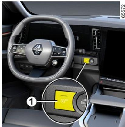
Drücken Sie den Schalter **1**, um die Funktion zu deaktivieren. Die Meldung „Stopp-und-Start deaktiviert“ leuchtet auf der Instrumententafel zusammen mit der Kontrolllampe des Schalters **1** auf.
