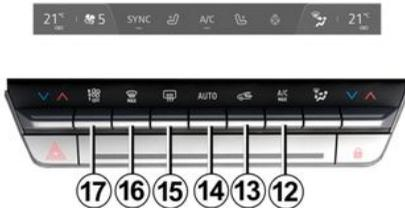
Die Taste **15** drücken und die integrierte Warnleuchte schaltet sich ein. Diese Funktion ermöglicht es, die Heckscheibe und die Außenspiegel entsprechend ausgestatteter Fahrzeuge schnell von Beschlag und Vereisung zu befreien.
