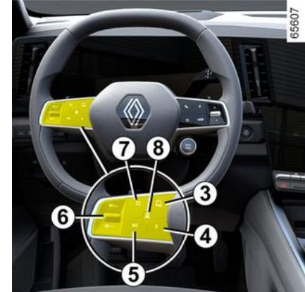
**3.** Schalter zum An-/Abwählen der Fahrhilfen, je nach Fahrzeugausführung:
