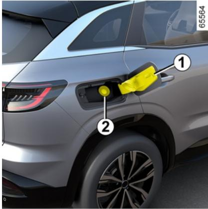
**Unbedingt** bleifreien Kraftstoff verwenden. Die Oktanzahl (RON) muss den Angaben auf dem Aufkleber in der Tankverschlussklappe **1** entsprechen → 415.
