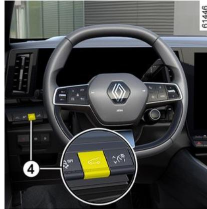
Zum Öffnen der Heckklappe Schalter **4** drücken und gedrückt halten, bis das Tonsignal ertönt, dann Schalter loslassen.
