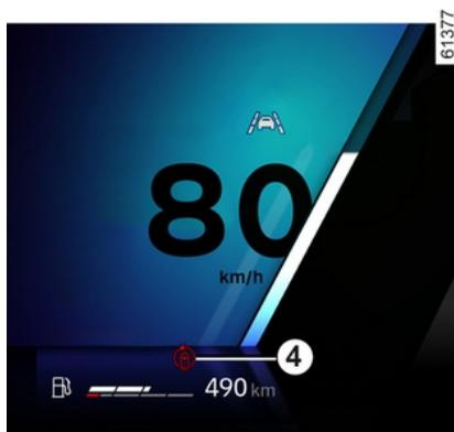
Beim Fahren ab einer Geschwindigkeit von ca. 65 km/h: wenn Sie sich einer (durchgehenden oder unterbrochenen) Linie nähern und die Gefahr eines Zusammenstoßes mit einem Fahrzeug besteht, das sich im toten Winkel **D** befindet und sich in die gleiche Richtung wie Ihr Fahrzeug bewegt, oder mit einem Fahrzeug, das sich auf einer angrenzenden Fahrspur schnell von hinten nähert und sich im Erfassungsbereich **E** befindet, wird das System aktiviert:
