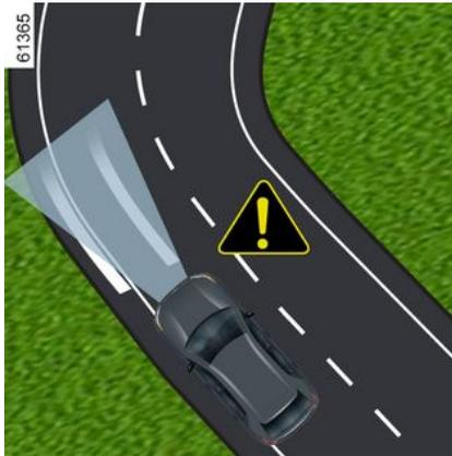
Im Falle einer engen Kurve ist je nach Fahrzeuggeschwindigkeit das seitliche Haltevermögen der Funktion begrenzt und erfordert ein sofortiges Eingreifen am Lenkrad durch den Fahrer, damit das Fahrzeug in der Spurmitte bleibt.
