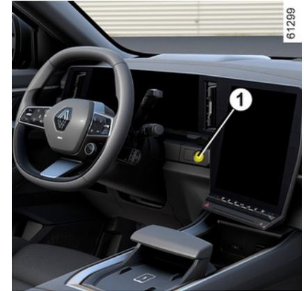
Drücken Sie den Schalter **1**, ohne die Pedale zu betätigen, um die Zündung einzuschalten. Drücken Sie das Bremspedal, und drücken Sie dann den Schalter **3**: Die Kontrolllampe **2** im Schalter und die Kontrolllampe
