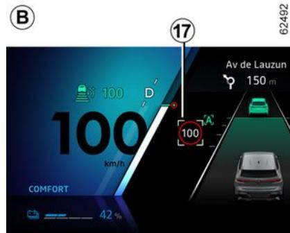
Anhand der Kamera, der Funktion „Verkehrszeichenerkennung“ → 242 und der mit dem Abonnement verbundenen Karte nimmt das System die automatische Anpassung der Fahrzeuggeschwindigkeit vorweg, bis das nächste Schild identifiziert ist **15**.
