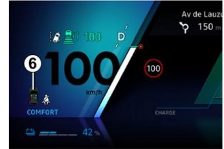
Wenn bei geschlossenen Türen die Zündung eingeschaltet wird, erscheint etwa 60 Sekunden lang die Grafik **6** an der Instrumententafel. Dies informiert den Fahrer jedes Mal über den Anlegestatus der einzelnen vorderen Sicherheitsgurte, wenn:
