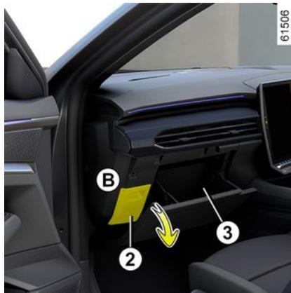
Die Sicherungen befinden sich hinter einer Klappe **2** im Handschuhfach **3**. Rasten Sie die Klappe **2** aus.
