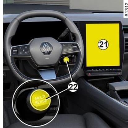
Über das Menü MULTI-SENSE auf dem Multimedia-Bildschirm **21** oder durch Drücken des Schalters **22** kann der Modus ECO aktiviert werden, der Einfluss auf die Temperatur hat und den Kraftstoffverbrauch des Fahrzeugs reduziert.
