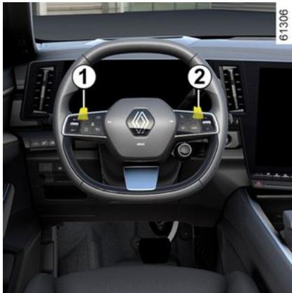
Sie können mit den Schaltwippen **1** und **2** die Stufe der regenerativen Bremsung ändern, wenn sich der Schalthebel in der Stellung D befindet.
