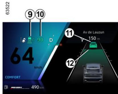
9. Kontrolllampe für den adaptiven Tempomaten mit Stop and Go-Funktion
