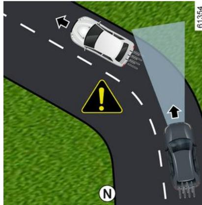
Wenn Sie in eine Kurve einfahren, erkennt das Radar bzw. die Kamera das vorausfahrende Fahrzeug möglicherweise vorübergehend nicht (siehe **N**).
