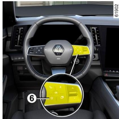
– Ein dritter Druckimpuls schaltet das Heizsystem auf minimale Heizleistung. Eine in den Schalter integrierte Warnlampe leuchtet auf;
