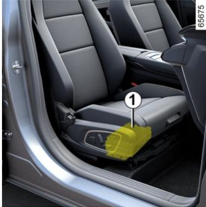
Je nach Fahrzeug befindet sich unter dem Beifahrersitz in einem speziellen Fach eine Sekundärbatterie **1**: Sie liefert die für den Betrieb einiger Geräte erforderliche Energie.
