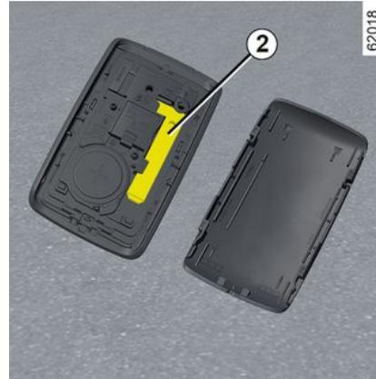
Der integrierte Schlüssel **2** kann zum Ver- oder Entriegeln der Fahrertür verwendet werden, wenn die Karte nicht funktioniert.
