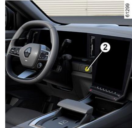
Wenn sich das Smartphone nicht mehr im Fahrgastraum befindet, wenn Sie versuchen, den Motor auszuschalten, wird eine Meldung auf der Instrumententafel angezeigt: Halten Sie die Start/Stopp-Taste des Motors **2** länger als zwei Sekunden gedrückt.
