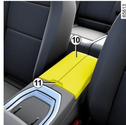
Öffnen Sie die Abdeckung **10** der mittleren Armlehne durch Drücken der Taste **11**.
