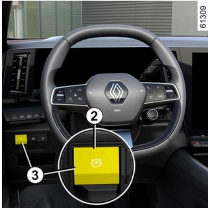
Ziehen Sie am Schalter **3**. Auf den Displays und Anzeigen leuchten die
