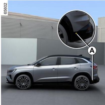
Unter Ausnutzung von Informationen von den Radarsensoren, die auf beiden Seiten am hinteren Stoßfänger (Bereich **A**) installiert sind, informiert das System den Fahrer, wenn ein anderes Fahrzeug im Erfassungsbereich **B** erscheint.
