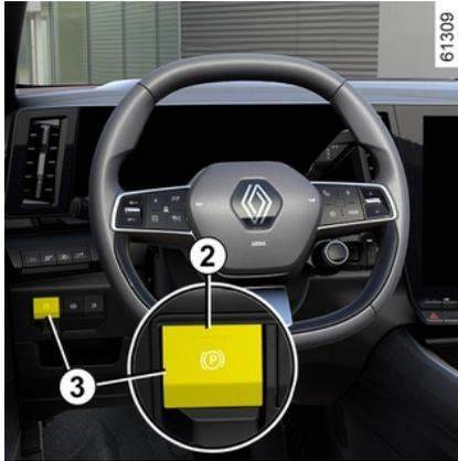
Um die elektrische Parkbremse manuell anzulegen (z. B. beim Halt an einer roten Ampel, im Stand bei laufendem Motor usw.), ziehen Sie den Schalter **3** und lassen ihn wieder los. Die Parkbremse wird beim Anfahren automatisch gelöst.
