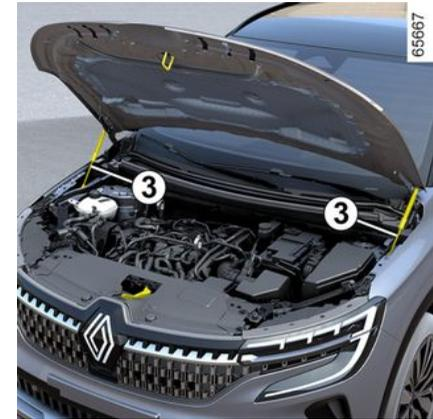
Motorhaube anheben und führen – die Motorhaube wird von zwei Streben gehalten **3**.
