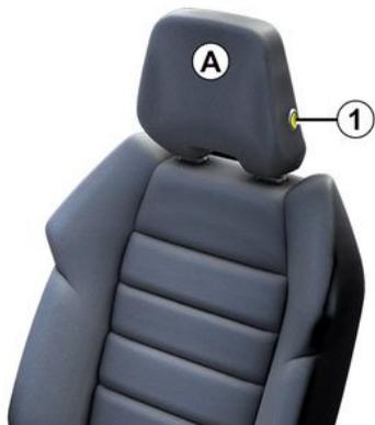
Ziehen Sie die Kopfstütze bis in die gewünschte Position nach oben. Überprüfen Sie die korrekte Verriegelung
