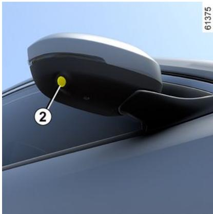
Die im Türspiegel eingebaute Kamera **2** überträgt eine Seitenansicht auf das Multimedia-Display **5**.
