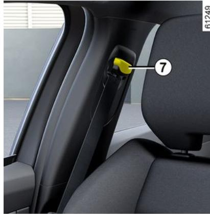
Drücken Sie die Taste **7**, um die Höhe des Sicherheitsgurtes so einzustellen, dass der Schultergurt wie zuvor gezeigt getragen wird. Drücken Sie die Taste **7** und lösen Sie den Sicherheitsgurt aus oder senken Sie ihn ab. Vergewissern Sie sich, dass der Sicherheitsgurt richtig eingerastet ist, nachdem Sie ihn angelegt haben.
