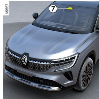
Je nach Fahrzeug ist das adaptive Fernlicht in mehrere unabhängige vertikale Segmente unterteilt. Diese Funktion nutzt die Kamera **7**, die sich hinter dem Innenspiegel befindet, um vorausfahrende und in Gegenrichtung fahrende Fahrzeuge zu erkennen.
