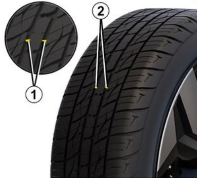
Wenn das Reifenprofil bis zu den Verschleißindikatoren abgenutzt ist, **werden diese sichtbar 2: Dann müssen die Reifen ausgetauscht werden, da die Profiltiefe höchstens 1,6 mm beträgt, was zu einer schlechten Straßenhaftung auf nassen Straßen führt.**
