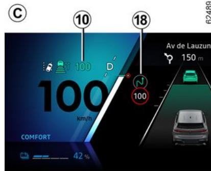
Mithilfe der Kamera, der Funktion „Verkehrszeichenerkennung“ → **242** und der mit dem Abonnement erworbenen Karte kann das System die automatische Anpassung der Fahrgeschwindigkeit **10** vorwegnehmen und verwalten, wenn sich das Fahrzeug einem Kreisverkehr oder einer Kurve nähert.
