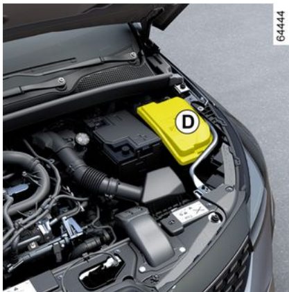
Sicherungen im Motorraum D
