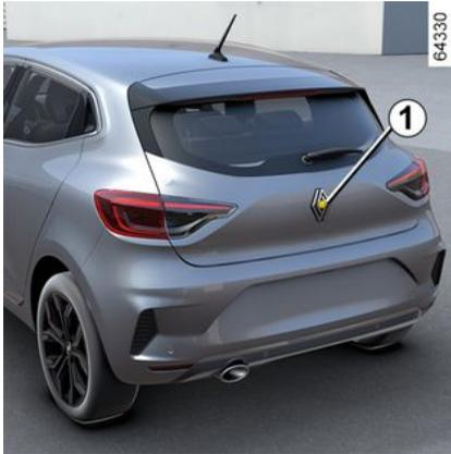
Wenn der Rückwärtsgang eingelegt wird, überträgt die an der Heckklappe befindliche Kamera **1** auf dem Multimedia-Display **2** eine Ansicht des Bereichs hinter dem Fahrzeug, begleitet von zwei Führungslinien **3** und **4** (beweglich oder fest).
