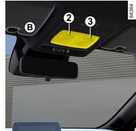
Drücken Sie auf den Schalter **2** für die Fahrerseite und den Schalter **3** für die Beifahrerseite, um folgende Funktionen auszulösen:
