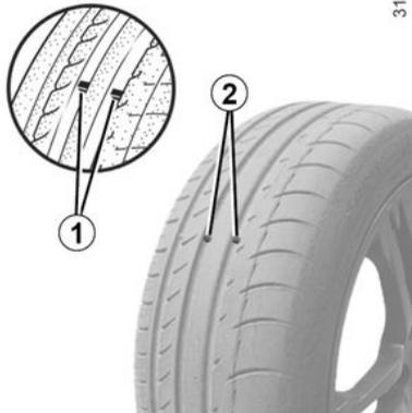
Die Reifen müssen sich in einem guten Zustand befinden und eine ausreichende Profiltiefe aufweisen: Die von unserer technischen Abteilung
