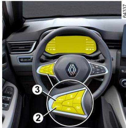
Die Reisegeschwindigkeit kann durch wiederholtes Drücken der folgenden Taste geändert werden:
