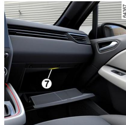
Je nach Fahrzeug wird das Licht **7** eingeschaltet, wenn das Handschuhfach geöffnet wird.
