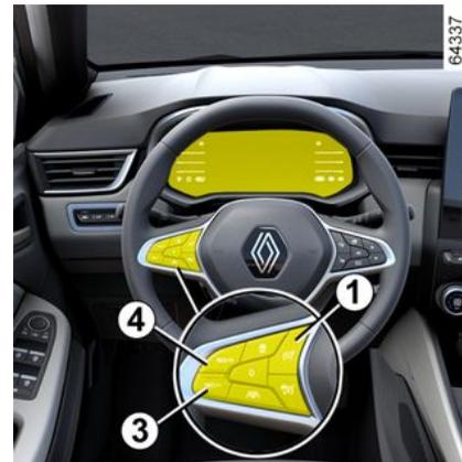
Wenn eine Geschwindigkeit eingestellt ist, fährt sich das Fahrzeug unterhalb dieser Geschwindigkeit wie eines ohne Geschwindigkeitsbegrenzer.
