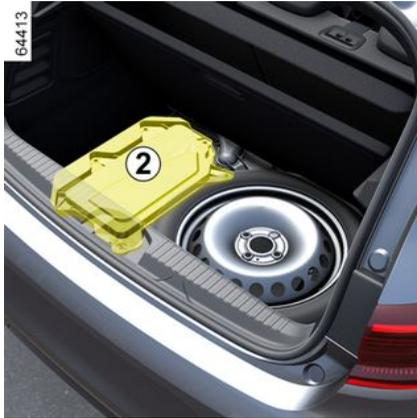
Die „12-Volt“-Zusatzbatterie **2** im Gepäckraum E-tech full hybrid liefert die Energie zum Entriegeln bzw. Verriegeln des Fahrzeugs sowie für die weitere Fahrzeugausstattung.
