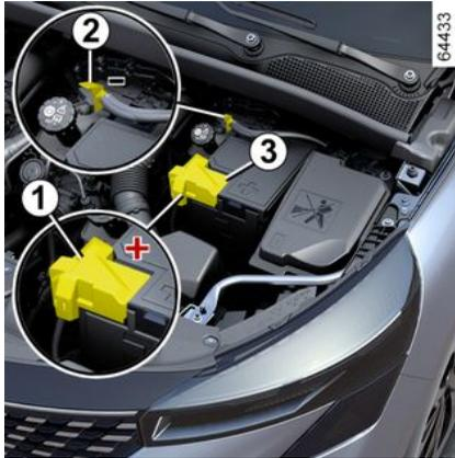
**Hinweis:** Bei der E-tech full hybrid-Version, ist Batterie ist nicht direkt zugänglich. Sie müssen daher die im Motorraum befindlichen Fernpole verwenden.
