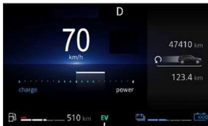
Die Kontrolllampe **2 EV** leuchtet in der Instrumententafel auf, um Sie darüber zu informieren, dass das E-tech full hybrid-System ausschließlich die elektrische Baugruppe zum Antreiben des Fahrzeugs verwendet.
