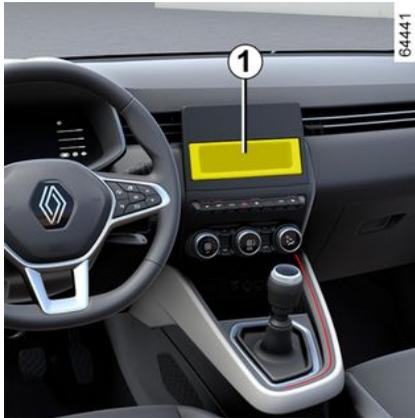
Entfernen Sie die Blende. Dahinter befinden sich die Anschlüsse (Antenne, Versorgung + und -, Lautsprecher).
