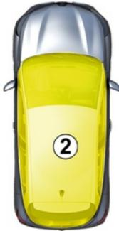
Wenn Sie die Karte bei sich tragen und die Türen und die Gepäckraumklappe geschlossen sind, entfernen Sie sich vom Fahrzeug: Es wird automatisch verriegelt, sobald Sie den Zugangsbereich verlassen **1**.
