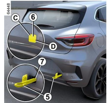
Drücken Sie auf den Bereich **C** während Sie an Bereich **D** ziehen, um die Klappe **6** zu öffnen.
