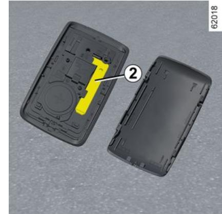
Der integrierte Schlüssel **2** kann zum Ver- oder Entriegeln der Fahrertür verwendet werden, wenn die Karte nicht funktioniert.
