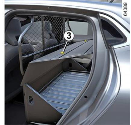
Rasten Sie die Halterungen **3** auf beiden Seiten der Heckablage aus und entfernen Sie diese durch die Gep ckraumt r.
