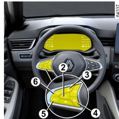
**2.** Mit ihm schalten Sie die Funktion (bei gespeicherter Fahrgeschwindigkeit) auf Standby (0).
