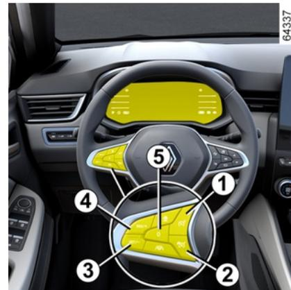
Durch Drücken des Schalters **5** (O) wird die Funktion des Geschwindigkeitsbegrenzers ausgesetzt.
