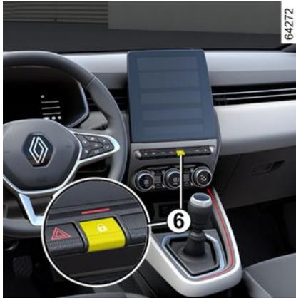
Der Schalter **6** steuert gleichzeitig die Türen, die Gepäckraumklappe und die Kraftstofftankklappe.
