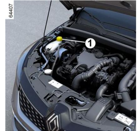
Bei abgeschaltetem Motor und Fahrzeug auf ebenem Untergrund stehend muss sich der Füllstand **bei kaltem Motor** zwischen den Marken „MINI“ und „MAXI“ am Kühflüssigkeitsbehälter **1** befinden.
