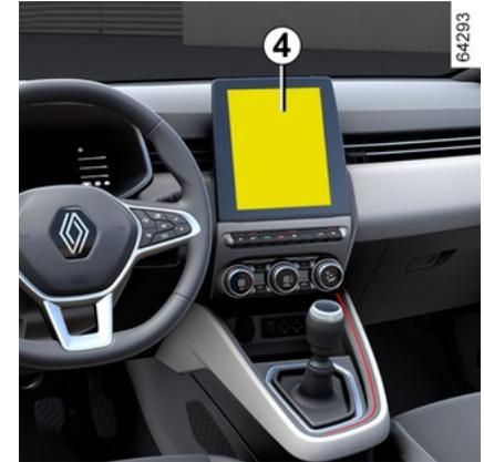
Drücken Sie bei stehendem Fahrzeug in der „FAHRZEUG“-Welt auf dem Multimedia-Display 4 auf das Menü „EINPARKHILFE“.
