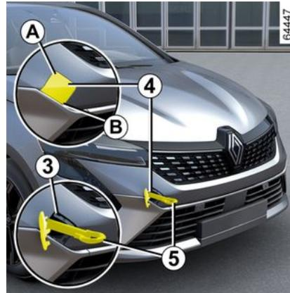
Drücken Sie auf den Bereich **A** und halten Sie ihn gedrückt, während Sie am Bereich **B** ziehen, um die Klappe **4** zu öffnen.
