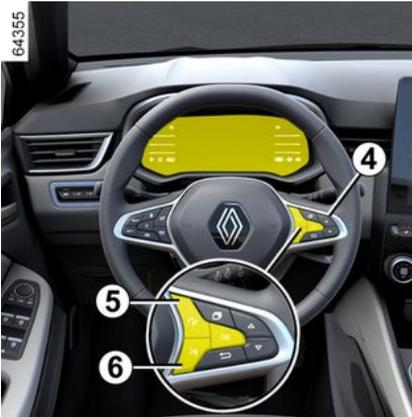
Bei damit ausgestatteten Fahrzeugen können Sie die Bedienelemente für Freisprecheinrichtung **5** und Spracherkennung **6** benutzen.
