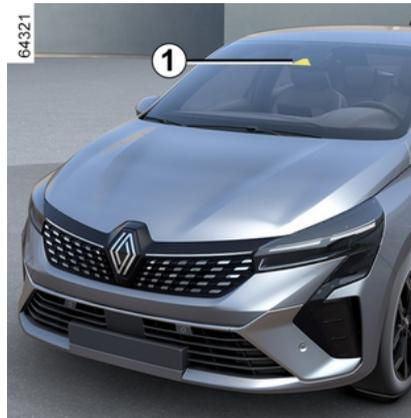
Anhand der Informationen der Kamera **1** löst die Funktion beim Überfahren einer durchgezogenen oder unterbrochenen Linie oder bei Annäherung an den Straßenrand (Spurtrenner, Leitplanke, Gehweg, Böschung usw.) eine Korrektur der Fahrzeuglenkung aus, ohne Aktivierung der Fahrtrichtungsanzeiger.
