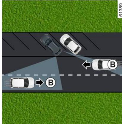
Unter Ausnutzung von Informationen von den Radarsensoren, die auf beiden Seite am hinteren Stoßfänger (Bereich **A**) installiert sind, informiert das System den Fahrer, wenn ein anderes Fahrzeug im Erfassungsbereich **B** erscheint.
