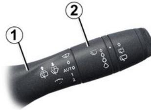
**Während der Fahrt** führt das Anhalten des Fahrzeugs zu einer Verringerung der Wischgeschwindigkeit.
