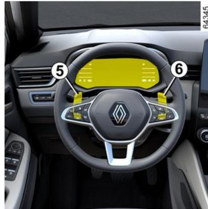
Je nach Fahrzeug können Sie mit den Schaltpaddel für den Gangwechsel **5** und **6** zum Schalten verwendet werden, sofern sich der Hebel in der Position D befindet.
