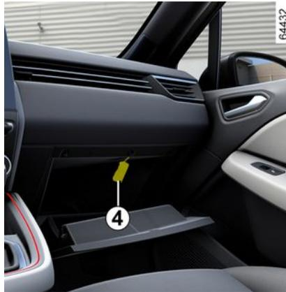
Rasten Sie die Leuchte **4** (mithilfe eines Flachklingen-Schraubendrehers o. Ä.) aus und drücken Sie dabei auf die Federzunge an der linken Seite. Die betreffende Lampe entnehmen.
