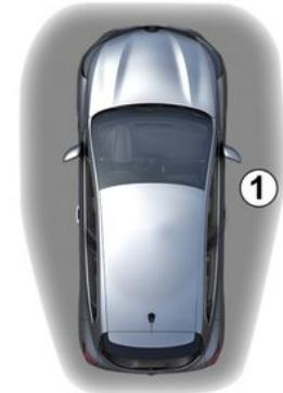
Wenn sich die Karte in der Zugangszone **1** befindet, wird das Fahrzeug entriegelt. Die Entriegelung wird durch **einmaliges Aufleuchten** der Warnblinker und der Seitenblinker angezeigt.
