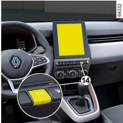
Drücken Sie bei eingeschalteter Zündung die Taste **14** oder bewegen Sie den Wählhebel auf Position P (bei Fahrzeugen mit Automatikgetriebe) oder den Schalthebel in den Rückwärtsgang (bei Fahrzeugen mit Schaltgetriebe), um die Funktion zu nutzen.
