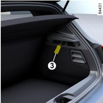
Rasten Sie die Leuchte **3** (mithilfe eines Flachklingen-Schraubendrehers o. Ä.) aus und drücken Sie dabei auf die Federzunge an der linken Seite. Die betreffende Lampe entnehmen.
