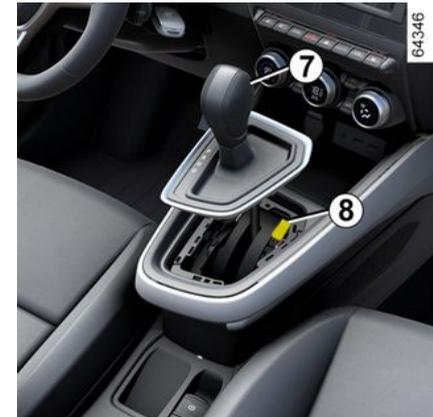
**Hängt der Hebel beim Anfahren** beim Betätigen des Bremspedals fest P (z. B. Batteriefehler), kann der Hebel manuell gelöst werden, um die Antriebsräder freizugeben.
