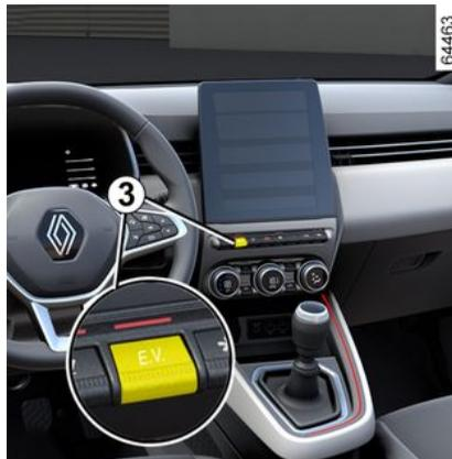
Wenn das E-tech full hybrid-System den Verbrennungsmotor und/oder den Elektromotor verwendet, um das Fahrzeug anzutreiben, ist es möglich, manuell in den vollelektrischen Modus umzuschalten.
