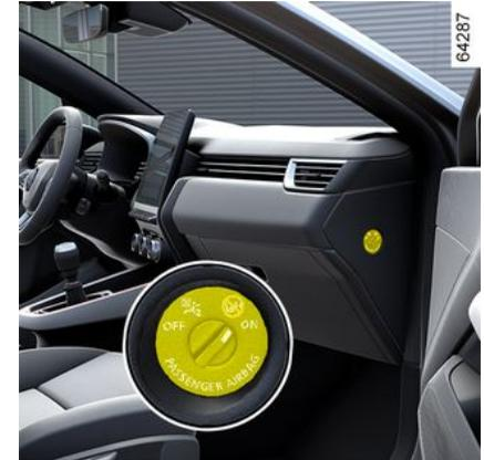
Aktivieren Sie die Beifahrerairbag wieder, sobald Sie den Kindersitz entfernen, um den Schutz des Beifahrers im Falle eines Aufpralls zu gewährleisten.
