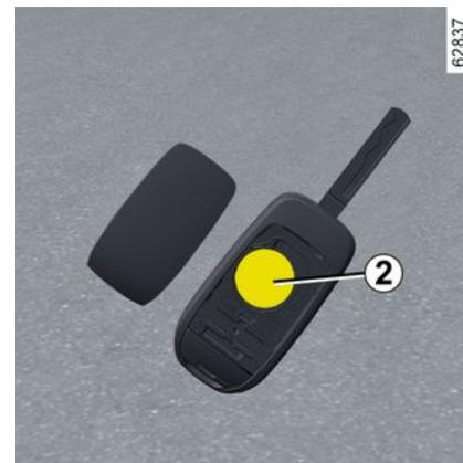
**Hinweis:** Den elektronischen Stromkreis im Deckel der Fernbedienung während des Batteriewechsels möglichst nicht berühren.
