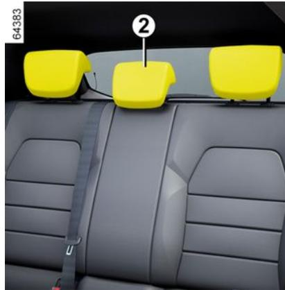
Setzen Sie das Gestänge in die Führungen ein und stecken Sie die Kopfstütze bis zur Arretierung ein, um die Kopfstütze in der oberen Stellung zu verwenden.
