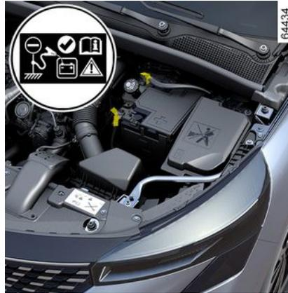
**i** Verwenden Sie Ihr E-tech full hybrid-Fahrzeug nicht, um Starthilfe an einer „12-V“-Batterie eines anderen Fahrzeugs zu leisten. Die elektrische Leistung in der „12-Volt“-Zusatzbatterie eines E-tech full hybrid-Fahrzeugs reicht hierfür nicht aus. **Es kann dadurch zu Schäden am Fahrzeug kommen.**
