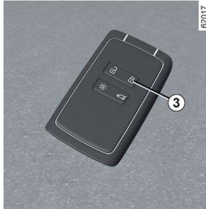
Wenn sich die Karte etwa 15 Minuten lang im Erfassungsbereich **1** befunden hat, wird die Fernverriegelung deaktiviert. Die Verriegelung des Fahrzeugs erfolgt durch Drücken der Taste **3**.
