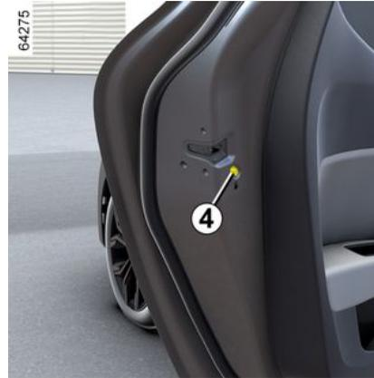
Um zu verhindern, dass die hinteren Türen von innen geöffnet werden können, den Hebel **4** umlegen und von innen prüfen, ob die Türen sicher verriegelt sind.
