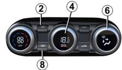
Drehen Sie das Betätigungselement 6. Die integrierte Kontrolllampe der ausgewählten Taste leuchtet auf.
