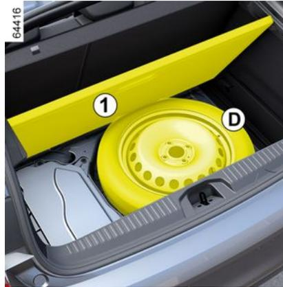
**i** Bei Fahrzeugen mit Notrad **D** kann das defekte Rad nicht anstelle des Notrads **D** untergebracht werden. Der Werkzeugsatz **4** muss mit der Zentralhalterung **3** befestigt werden, der defekte Reifen muss im Gepäckraum untergebracht werden.
