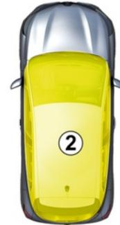
**Wenn bei laufendem Motor** eine Tür geöffnet und geschlossen wird und sich die Keycard danach nicht mehr im Bereich **2** befindet, erscheint die Meldung „Chipkarte nicht gefunden“, um darauf hinzuweisen, dass sich die Keycard nicht mehr im Fahrzeug befindet. Dadurch kann zum Beispiel ein Wegfahren nach dem Absetzen eines Fahrgasts, welcher die Keycard bei sich trägt, verhindert werden.
