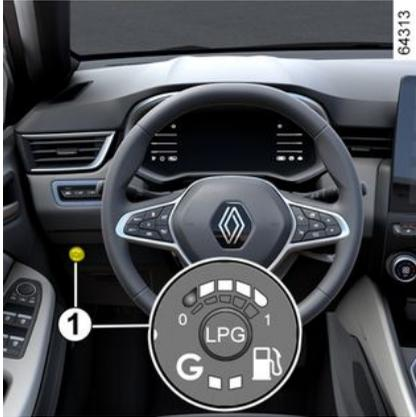
Diese Fahrzeuge arbeiten im Bi-Fuel-Betrieb mit zwei Arten von Treibstoff: LPG und Benzin.
