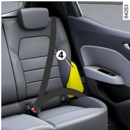
Stellen Sie sicher, dass keine Gegenstände oder Flüssigkeiten in die Luftdüse 4 gelangen.
