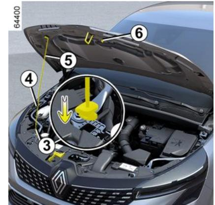
Heben Sie die Motorhaube an, lösen Sie die Haltestange **5** mittels des Griffs **4** aus ihrer Aufnahme **6**. Anschließend **muss** die Haltestange zu Ihrer eigenen Sicherheit in der
