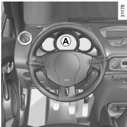
Quadro della strumentazione A: potete regolare l'intensità luminosa dal computer di bordo.
