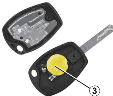
**Nota:** quando si sostituisce la pila, si raccomanda di non toccare il circuito elettrico nella chiave.
