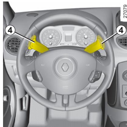
Le levette **4** consentono di cambiare marcia quando la leva è in posizione «modalità manuale» o, se il veicolo è in movimento, in «modalità automatica».
