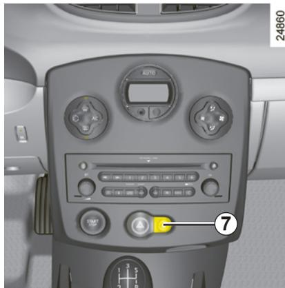
Per bloccare le serrature lasciando una parte apribile aperta (trasporto di oggetti con il bagagliaio aperto...), o quando il veicolo è situato in una zona caratterizzata da un'elevata presenza di onde elettromagnetiche, o in caso di guasto della chiave o della carta RENAULT: con contatto disinserito, premete per oltre cinque secondi il contattore 7.
