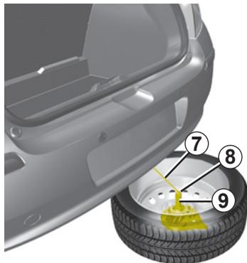
Dopo la sostituzione della ruota, mettetela sul supporto **9**, con la valvola rivolta verso il suolo. Fissate il cavo **7** nella relativa sede **8** quindi spingete la ruota sotto il bagagliaio.
