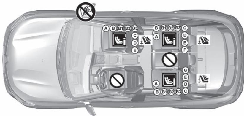
Pour la place passager avant, il est préconisé d'utiliser un siège enfant avec jambe de force afin d'éviter de déclencher le signal de non-port de la ceinture.
