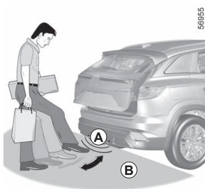
Le capteur détecte l'approche puis l'éloignement de votre pied et déclenche l'ouverture ou la fermeture du hayon.
