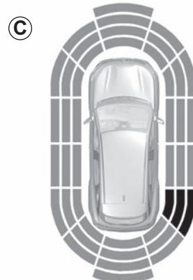
Selon la distance de l'obstacle, la fréquence du signal sonore sera plus élevée en approche jusqu'à devenir continue vers 20 cm environ pour un obstacle sur les côtés et 30 cm environ pour un obstacle à l'avant ou à l'arrière. Les zones vertes, orange (ou jaunes suivant véhicule) et rouges s'afficheront sur l'afficheur **C**.
