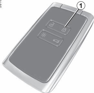
Lorsque le véhicule est équipé de la supercondamnation, celle-ci permet de verrouiller les ouvrants et d'empêcher l'ouverture des portes par les poignées intérieures (cas d'un bris de glace suivi d'une tentative d'ouverture des portes par l'intérieur).
