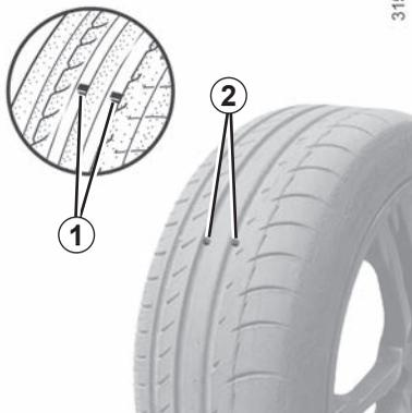
Lorsque le relief des sculptures a été érodé jusqu'au niveau des bossages-témoins, **ceux-ci deviennent visibles 2** : il est alors nécessaire de remplacer vos pneumatiques car la profondeur des sculptures n'est, au plus, **que de 1,6 mm et ceci entraîne une mauvaise adhérence sur les routes mouillées**.
