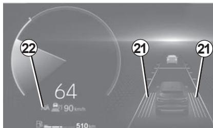
Si le conducteur n'intervient pas, la fonction émet une vibration dans le volant pour signaler que le véhicule s'apprête à franchir une ligne et qu'une action immédiate du conducteur est nécessaire.
