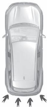
En complément de la fonction « Aide au parking » ➔ 2.144 et à partir des informations provenant des quatre capteurs centraux situés à l'arrière du véhicule, le système détecte les obstacles fixes se situant derrière votre véhicule. Si le risque de collision est important, le système freine automatiquement le véhicule.
