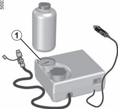
Suivant véhicule, en cas de crevaison, utilisez le kit situé dans le coffre, sous le plancher mobile.
