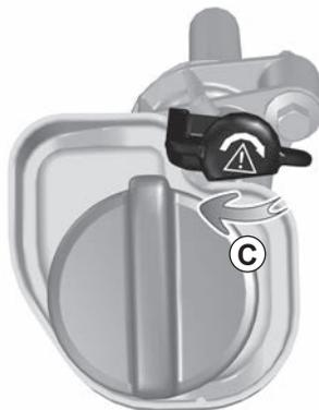
Suivant véhicule, il est nécessaire de verrouiller la jauge à huile : enfoncez la jauge jusqu'en butée, puis effectuez une rotation pour le verrouillage (mouvement **C**).
