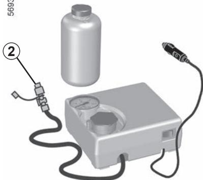
Une fois que le pneu est correctement gonflé, déposez le kit : dévissez lentement l'embout de gonflage de la bouteille **2** de manière à éviter la projection de produit et stockez la bouteille dans un emballage plastique pour éviter l'écoulement du produit.
