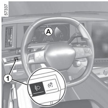
**Tableau de bord A** : il s'éclaire à l'ouverture de la porte conducteur. Appuyez sur le contacteur **1** autant de fois que nécessaire pour régler l'intensité lumineuse.
