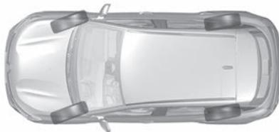
Lors de roulage à vitesse plus élevée, les roues arrière s'orientent dans le même sens que les roues avant (figure **B**) afin d'optimiser la stabilité du véhicule. Ceci est utile lors d'un changement de voie, lors de la prise de virage...
