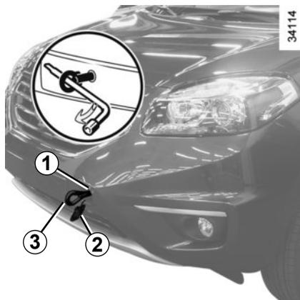
Utilisez exclusivement le point de remorquage avant 1 et le point de remorquage arrière 4 (jamais les arbres de transmission). Ces points de remorquage ne peuvent être utilisés qu'en traction, en aucun cas ils ne doivent servir pour soulever directement ou indirectement le véhicule.
