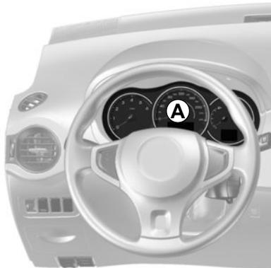
Die **Instrumententafel A** wird beim Einschalten der Zündung beleuchtet. Beim Aufleuchten bestimmter Kontrolllampen erscheinen gleichzeitig Meldungen an der Instrumententafel.
