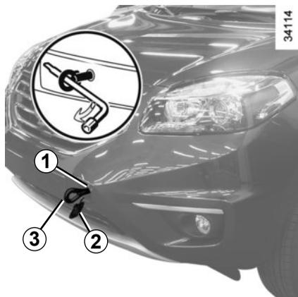
Verwenden Sie ausschließlich die Abschleppöse vorne 1 und die Abschleppöse (hinten) 4 (niemals die Antriebswellen). Die Abschleppösen sind ausschließlich für Belastung durch Zug ausgelegt und dürfen nicht verwendet werden, um das Fahrzeug direkt oder indirekt anzuheben.
