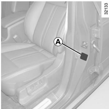
Der Reifendruck ist auf dem Aufkleber **A**, der auf der Fahrertürkante angebracht ist, angegeben.
