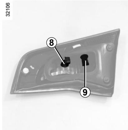
Lösen Sie den Lampenträger **8** bzw. **9** um eine Viertelumdrehung und tauschen Sie die Lampe aus.
