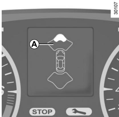
Nel caso in cui un ostacolo sia presente nella parte anteriore e posteriore del veicolo, soltanto quello più vicino verrà preso in considerazione e si udirà il segnale acustico corrispondente. Se un ostacolo viene rilevato nello stesso tempo nella parte anteriore e in quella posteriore in una zona di rilevamento inferiore a 30 centimetri, segnali acustici anteriori e posteriori risuoneranno alternativamente.
