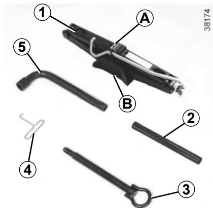
Gli attrezzi per la sostituzione della ruota sono situati nel bagagliaio sotto il tappetino. Durante la sistemazione degli attrezzi fissate correttamente il cric, con la base **B** tassativamente verso il basso.
